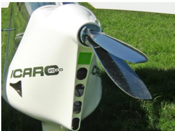
L'hélice rétractable en fibre de carbone a été spécialement développée pour le moteur électrique.
